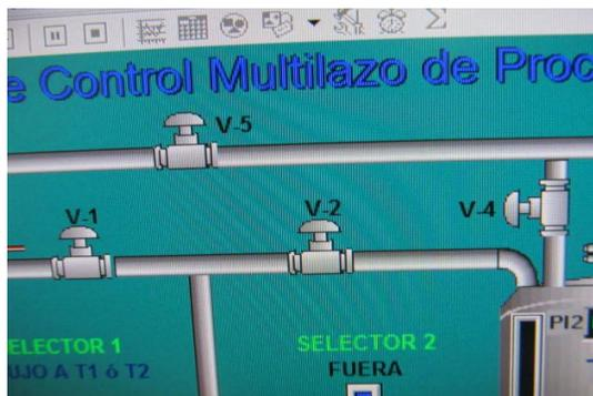
25) Ajustar la posición de apertura de la válvula de control moviendo la Señal de SALIDA del controlador de Flujo FIRC-1 y del controlador registrador indicador de Nivel LIRC-2, la escala es de 0 a 100 %. Se puede elegir un valor del 50 %.
