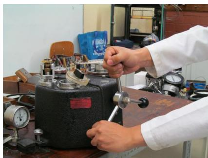
22) Cerrar el tanque de alimentación de aceite, tomando la agarradera negra del tanque, procurando que la punta del tornillo embone en el fondo del tanque.
