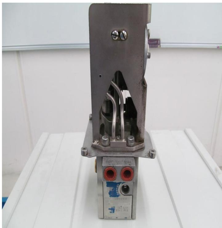
**Figura 2.10.** Cara frontal del Transmisor Neumático. Suministro de Aire (SUP) de 20 lbf/pulg<sup>2</sup> y Señal de Salida de aire (OUT) del transmisor de 3 a 15 lbf/pulg<sup>2</sup>. También se tiene el Fuelle de Retroalimentación.
