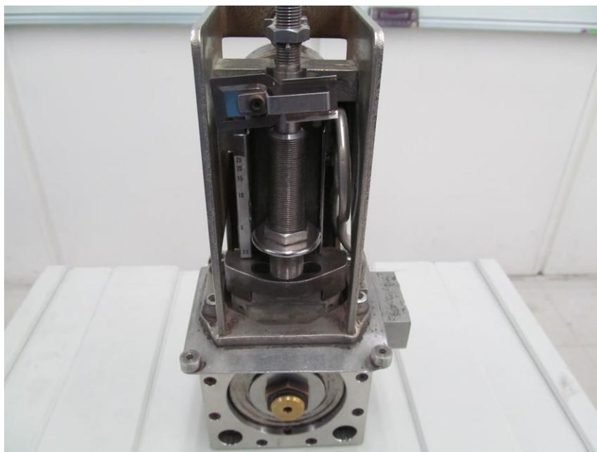
**Figura 2.8.** Cara lateral del Transmisor Neumático (Diafragma de Baja Presión, Barra de Equilibrio y Rodaja del Ajuste de Rango o Ajuste de Gama)
