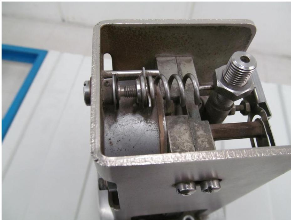
**Figura 2.7.** Ajuste de Elevación o Supresión del Transmisor Neumático (Tornillo que interconecta Resorte de Bias y la Barra de Equilibrio o Barra de Fuerza).
