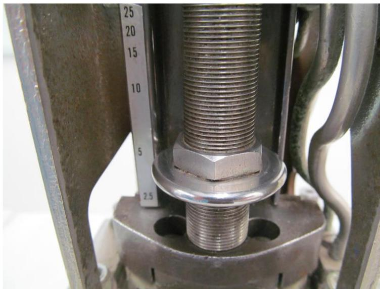
**Figura 2.9.** Ajuste de Rango (Escala 2.5 a 25 pulgadas de agua)
