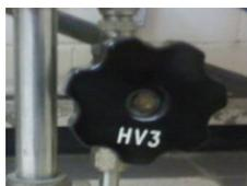
Si se quiere subir el valor de la variable accionar bomba unos segundos con las válvulas HV5 y HV3 cerradas.
